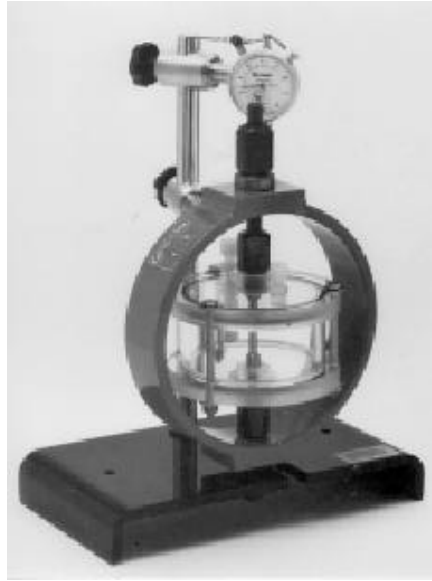
Fig. II. 7. Montage pour le test d'évaluation de la résistance à la fissuration sous contrainte induite en présence de l'hydrogène sulfuré selon la norme NACE TM 0177
